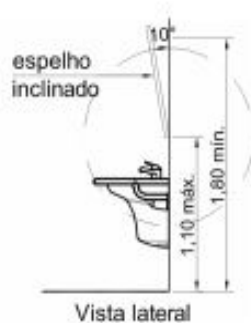
Figura 17 – Esquema de instalação do espelho.
