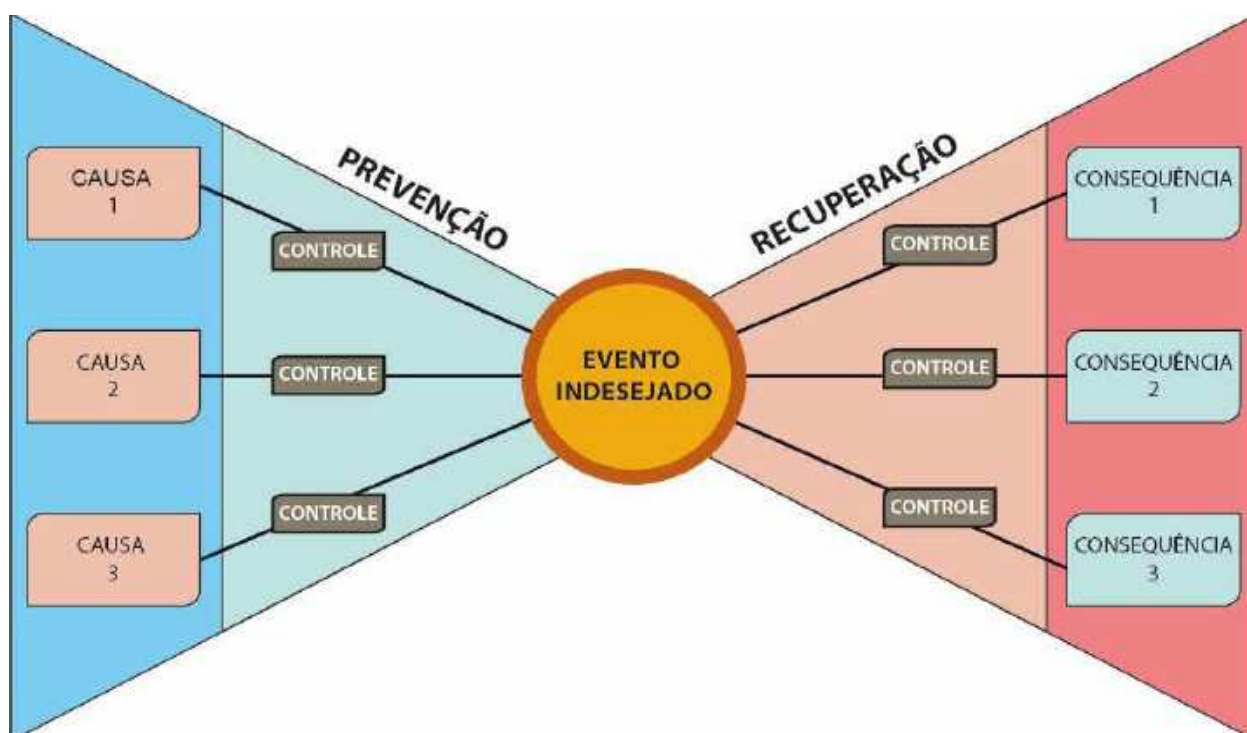
Figura 3 – Identificação de riscos utilizando a técnica bow tie
